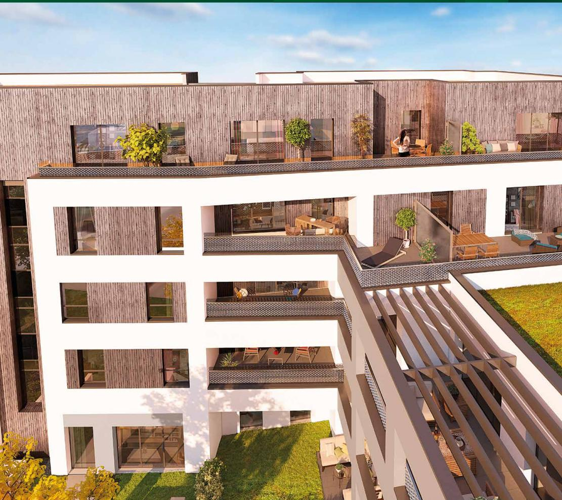
Soubassements, murets en béton matricé, façades en briques, peinture en gris soutenu, attiques en retrait en bardage bois pré-grisé, ouvrage de serrurerie pour balcon en métal déployé teintes gris anthracite, menuiseries en aluminium gris anthracite, béton « vert » (ciment décarboné)...
